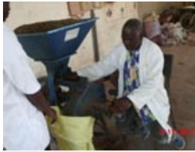
Figure 5 : Broyage d'épluchures de manioc
